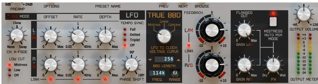
Section de contrôle de traitement du signal.
