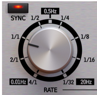
Einstellung der LFO-Frequenz bei aktivierter Synchronisation
